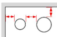
In der praktischen Anwendung müssen die Minimalabstände zwischen den verschiedenen Leitungstypen und/oder den Leitungen und der Schottlaibung, die in der Prüfung verwendet wurden, eingehalten werden.
