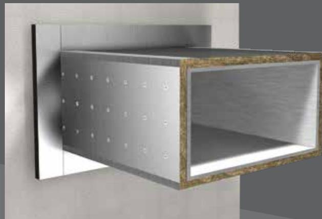
Un collier en laine minérale de 120 mm de large et de 60 mm d'épaisseur doit être installé en périphérie des deux côtés du trou. Le même matériau peut être utilisé pour le revêtement ignifuge. Le collier en laine minérale peut être fixé avec de l'adhésif ignifuge à base de silicate.
