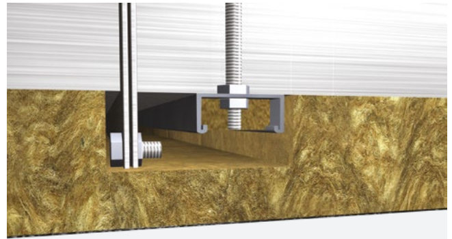
Detail der Kanalverbindungen und Aufhängungen
